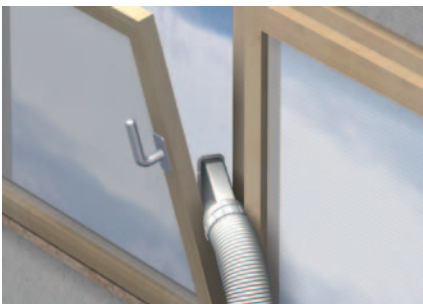
Abb. 6 Abluft bei gekipptem Fenster
