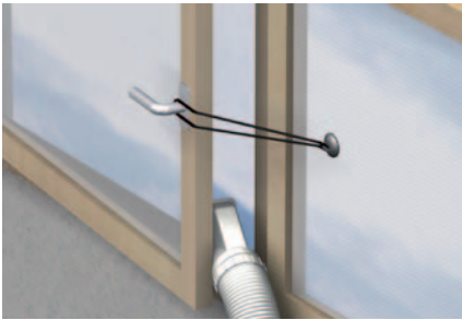
Abb. 5 Abluft bei geöffnetem Fenster
